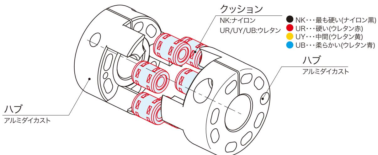
クッション式カップリングは、ハブの突起に囲まれた円筒型のクッションが変形することで偏心・偏角や回転振動を吸収します。6個のクッションは完全に独立しているので、それぞれが最も効果的に変形してミスマライメントや回転振動への対応を容易にしています。
