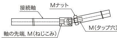
**注意** 軸結合部はロックタイト等、強力接着材で固定して下さい。
