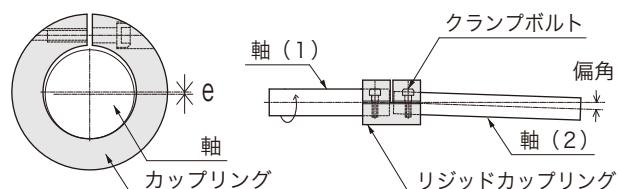
(図4) カップリングと軸の断面(拡大) (図5) カップリングと軸の固定法
