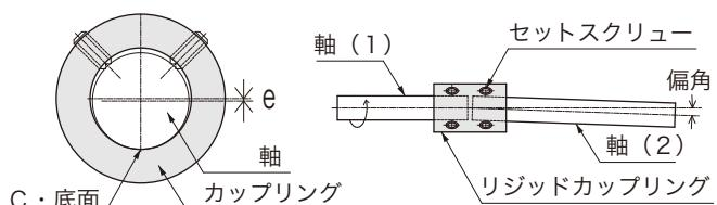
(図2) カップリングと軸の断面(拡大) (図3) カップリングと軸の固定法
