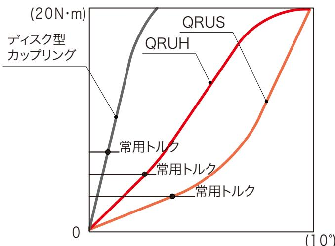
QRUタイプは、ねじりばね定数が低負荷トルクでは小さく、高負荷トルクで大きくなります。従って、精度のない回転機構、振動を伴う装置等に適しており、常用トルクに対し最大トルクが3倍以上で、破損に強いカップリングです。
