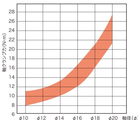
QRU40の軸クランプ力と、軸径の関係を実測した結果、図のような帯状のグラフが得られました。小径軸ほどクランプ力が減少しますので、キー結合の必要性が生じる事もあります。
