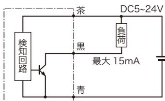
※1 ケーブルオプションによる変換・電流増幅・ケーブル延長・表示灯の追加が可能です。その他詳細は P.103~108 をご参照ください。
